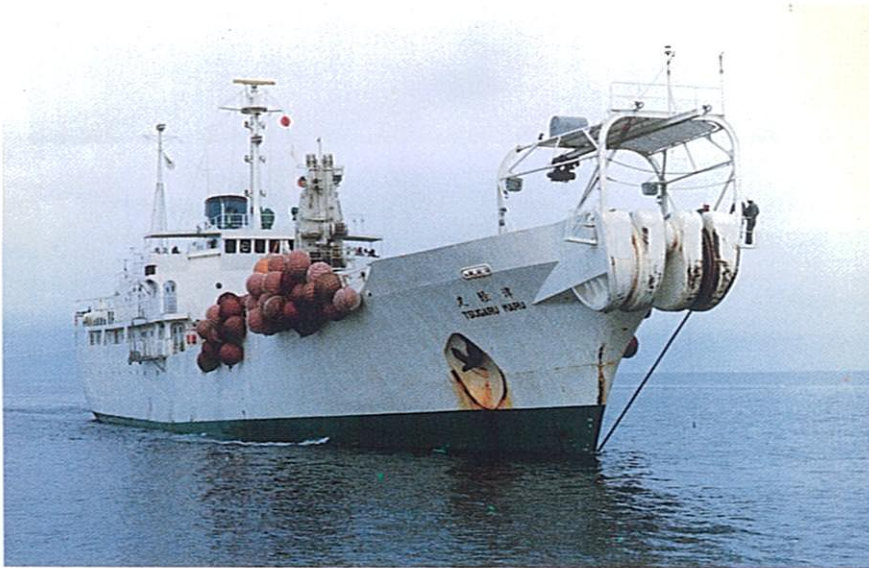
◀陸揚げを終え、砂原向けケーブルを敷設中の「津軽丸」
