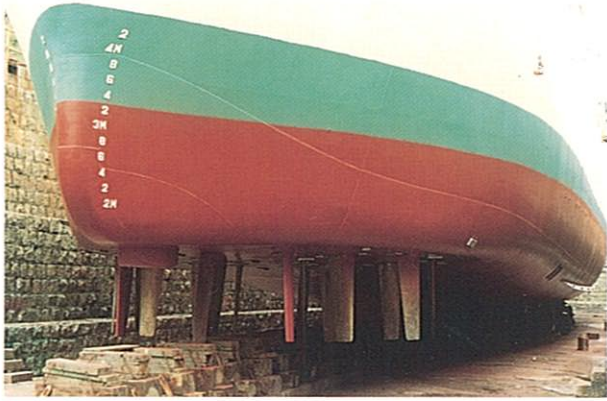
▲船首船底に取付けられたトロコイダルプロペラ。
