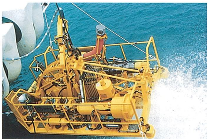
▲高機能埋設機の機能テスト中。
