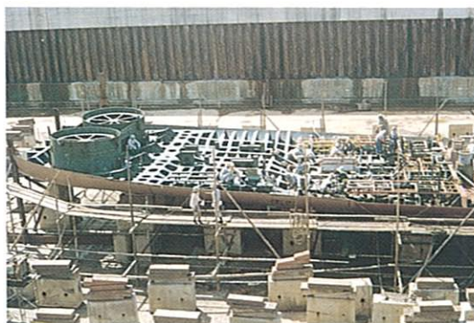
▲ドライドック内に据えられた船体の一部
