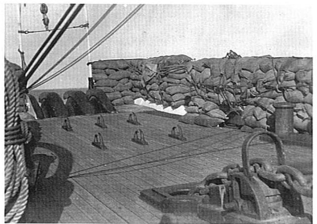
▲船首作業甲板の防護
