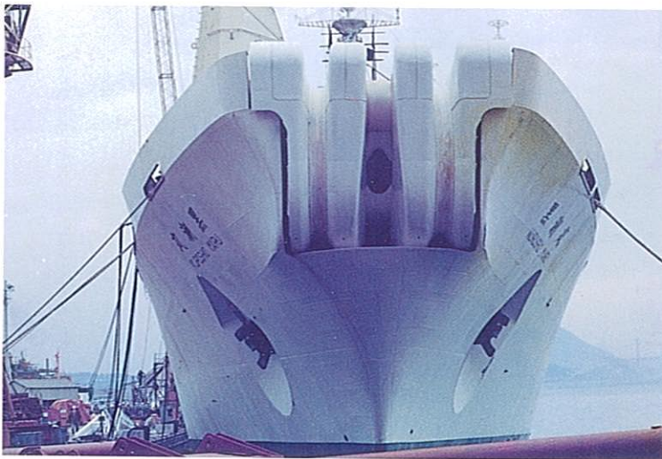
▲船首バウ・シーブ (車輪直径3.0m)
