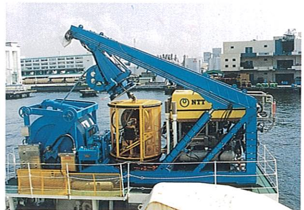
▲船尾。着水・揚収装置上のブークルと中継基地。
