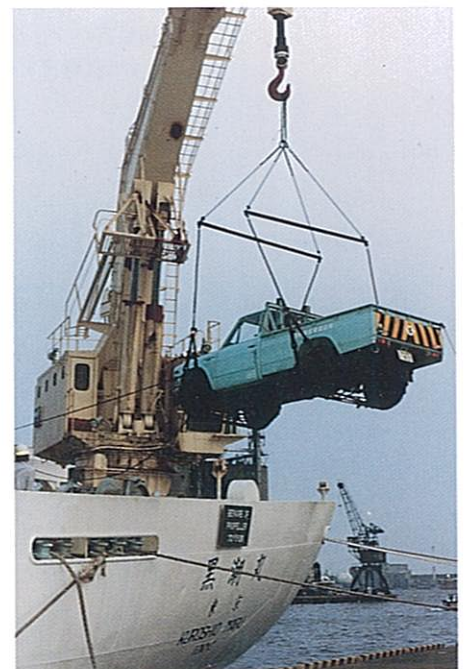
▲昭和58年10月三宅島大噴火の際、 救援資材を積込む黒潮丸。 (シーリフトクレン捲揚能力20トン)
