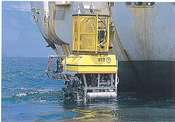
▲昭和63年国際調達した、水中ROVの機能確認のため海洋実験中。
