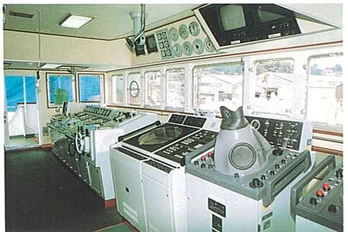
▲ 光洋丸操舵室内の諸装置可変ピッチプロペラ制御装置。操舵装置、レーダ等が見える。
