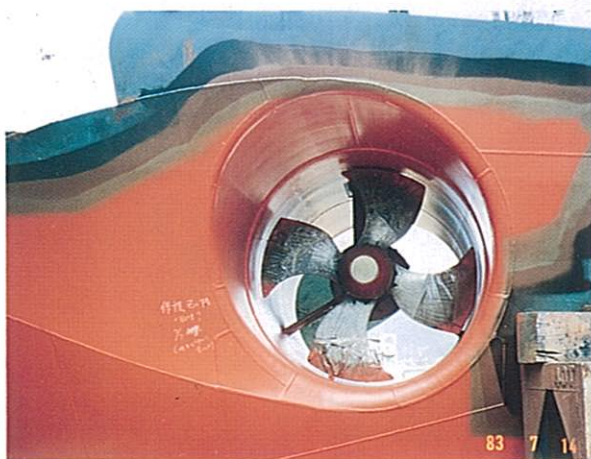
▲船首吃水線下に装備されたハイスキュード型スラスタ。使用時、従来形スラスタに比べ振動、騒音が少ない。ピッチの変更は油圧で行われる。(出力400PS)
